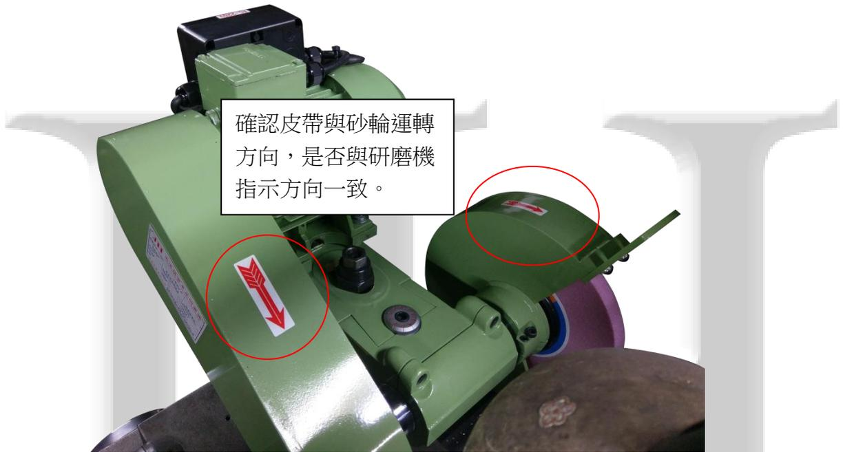
4. 進行研磨時，車床轉動方向，需與研磨機指示方向一致。
