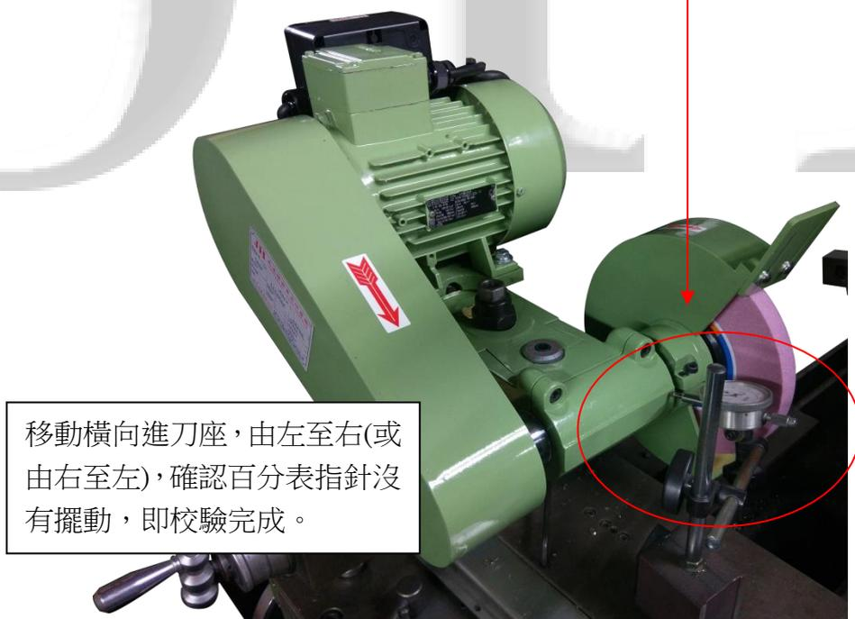
4. 利用尾座頂針校驗研磨機與車床垂直高度。尾座頂針與對準研磨機皮帶輪中心點。
