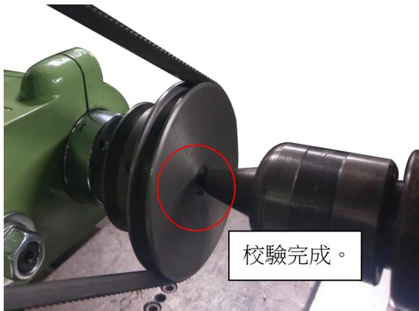
5. 調整皮帶鬆緊度。因調整研磨機高度時，會影響皮帶鬆緊，故調整完研磨機高度，需在確認一次皮帶鬆緊度。其皮帶鬆緊度，在運轉情況下皮帶不會有明顯的擺動即可。
